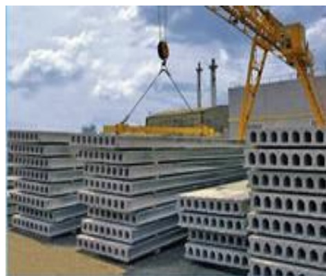
Плиты перекрытия ПК
